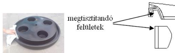
14. kép: Csatlakozási felületek tisztítása
